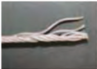
EFFILOCHAGE Câble visiblement distendu ou déroulé
